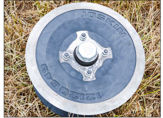
Neue Scheibe aus Metal und Nitrilkautschuk (NBR)
