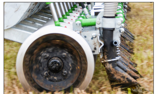
Neue Befestigung des Schlauches an der Muffe und neue hydraulische Tropfstopp-Elemente
